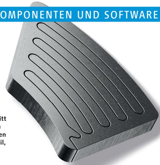
Der Serpentinausschnitt des Snakeline-Magneten erzeugt zwei Dimensionen isolierender Linien im Teil, was eine Wirbelstromreduzierung bewirkt
