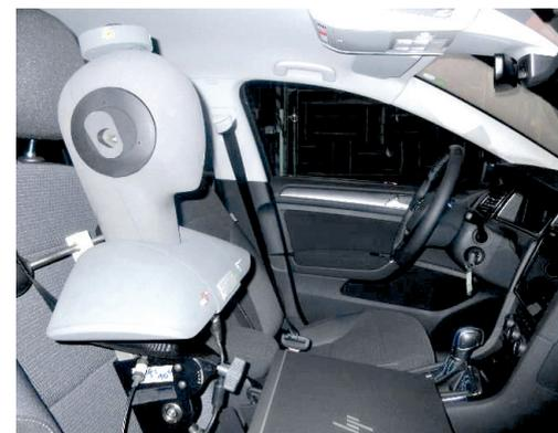
**11** Einbau des Prototyps mit CFK-Deckel in ein Serienfahrzeug zum Betrieb auf Rollenprüfstand, Applikation der Messensorik (links) und Kunstkopf im Fahrzeuginnenraum (rechts)
