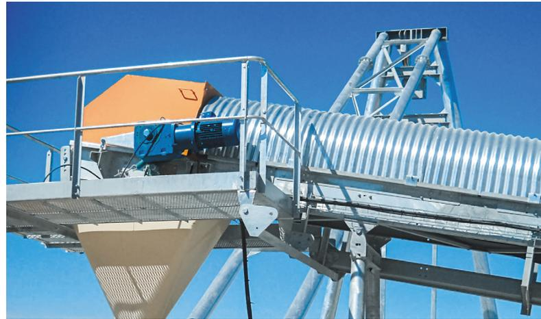
Industriegetriebemotor im Blockgehäuse als Antrieb eines Gurtförderers
